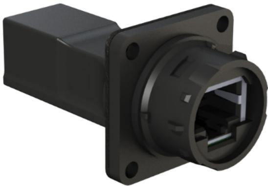
Der EMOSAFE EN-10HG besitzt eine extrem robuste, staub- und wassergeschützte Steckerkupplung. Eingebaut in ein entsprechend geschütztes Gehäuse und in Kombination mit dem optional erhältlichen IP67-Steckergehäuse Z-1 erreicht er die Schutzklasse IP67. Außerdem bietet das IP-67 Steckergehäuse Z-1 eine zusätzliche Zugentlastung. Somit eignet sich der EN-10HG auch für Geräte im Außeneinsatz und/oder für Umgebungen in denen außergewöhnliche mechanische Belastungen auf Kupplung oder Kabel einwirken.
