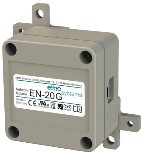
Der Netzwerkisolator EMOSAFE EN-20G bietet in Bezug auf die Netzwerkanbindung die Voraussetzung für den sicheren Betrieb eines Medizingerätes in der Patientenumgebung. Der EN-20G erfüllt alle konstruktiven Voraussetzungen der IEC 60601-1, um innerhalb der Netzwerkschnittstelle zwei Schutzmaßnahmen zum Patientenschutz (2 MOPP) auszubilden und das Risiko eines elektrischen Schlages aufgrund einer Fremdspannung am Netzwerkanschluss für Patient und Bediener nahezu zu eliminieren.
