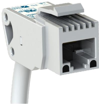
Der EMOSAFE EN-60KDS ist ein leistungsfähiger und kompakter Gigabit-Netzwerkisolator der sich durch hervorragende Ethernetperformance und eine sehr hohe Spannungsfestigkeit auszeichnet. Als Keystone-Modul kann er in jede Auslassblende, jedes Patchpanel und jeden Gehäusedurchbruch eingesetzt werden, der den Keystone-Spezifikationen entspricht. Sein rückseitiges Anschlusskabel verleiht ihm den Charakter einer Verlängerung.
