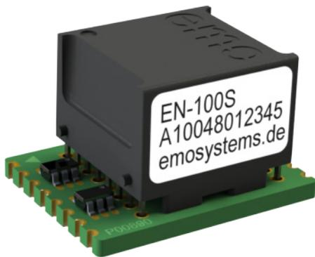
Netzwerkisolatoren des Typs EMOSAFE EN-100S sind für die Integration auf der Leiterplatte eines Gerätes vorgesehen. Der EN-100S wird auf der Leiterplatte verlötet und zeichnet sich durch extra kurze Lötanschlüsse aus. Durch die äußerst kompakte Bauart ist er auch noch bei sehr beengten Platzverhältnissen verwendbar. Zusätzliche TVS-Dioden schützen einzelne Adernpaare vor Spannungsspitzen.
