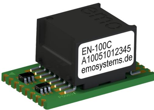
Netzwerkisolatoren des Typs EMOSAFE EN-100C sind für die Integration auf der Leiterplatte eines Gerätes vorgesehen. Der EN-100C wird auf der Leiterplatte verlötet. Durch die äußerst kompakte Bauart ist er auch noch bei sehr beengten Platzverhältnissen verwendbar. Zusätzliche TVS-Dioden schützen einzelne Adernpaare vor Spannungsspitzen.
