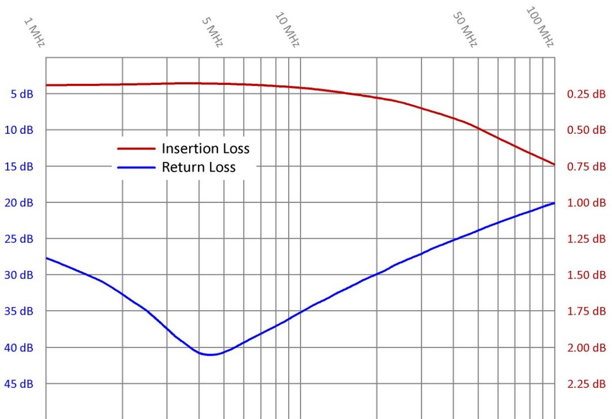
Typische Frequenzgänge für die Einfügedämpfung (Insertion Loss) und die Rückflussdämpfung (Return Loss) eines Netzwerkisolators EMOSAFE EN-70HD.
