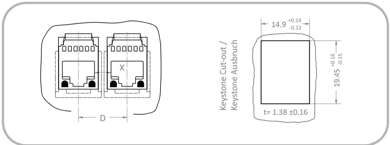
Der Mittenabstand „D“ zwischen zwei benachbart angeordneten Netzwerkisulatoren ist abhängig von den geforderten Luft und Kriechstrecken zu wählen. Ausschlaggebend ist hier i.d.R. der kürzeste Abstand „X“ zwischen den Schirmblechen der eingesteckten RJ45-Stecker. Siehe auch Abschnitt **6.6 MONTAGE IN MEHRFACHMODULTRÄGERN**.
