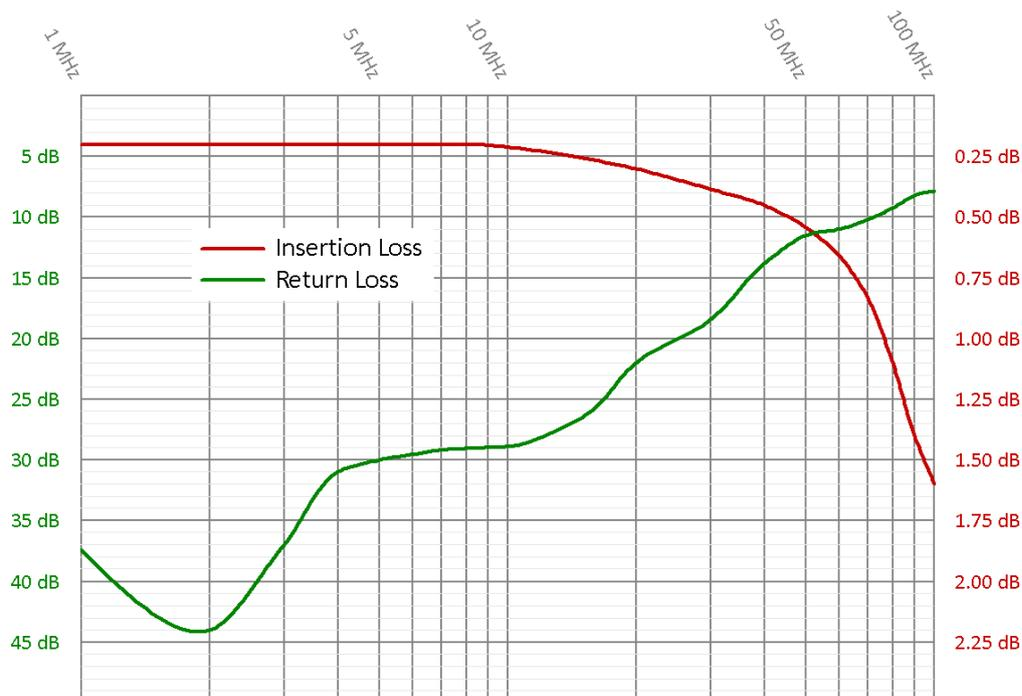
Typische Frequenzgänge für die Einfügedämpfung (Insertion Loss) und die Rückflusdämpfung (Return Loss) eines Netzwerkisolators EMOSAFE EN-30.
